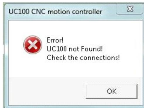
La schermata seguente appare se Mach3 perde la connessione con UC100 durante le operazioni. Può accadere se il cavo USB è rotto e/o fa falso contatto e/o minaccia di uscire dal lato del PC o dal lato della UC100. Per eliminare l'errore sostituire il cavo danneggiato, o disinserirlo e inserirlo più accuratamente nei connettori, e riavviare Mach3.
